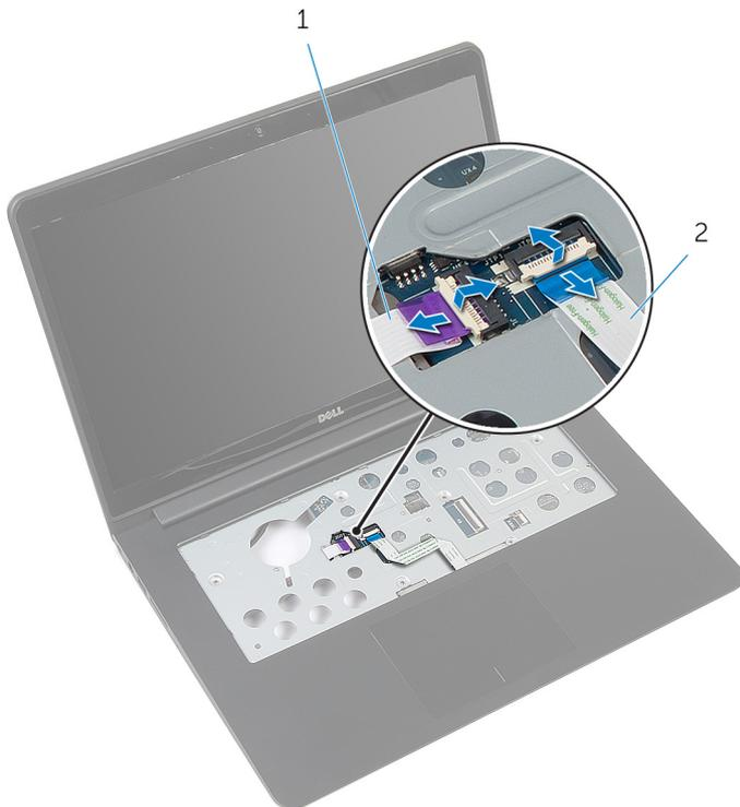
1 Kabel plošče za lučke stanja      2 Kabel sledilne ploščice
